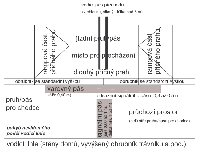
Obrázek 27: Příklad řešení hmatových úprav pro nevidomé a slabozraké na místech pro přecházení s dlouhými integrovanými prahy (v případě dělicího ostrůvku se neprovádí odsazení signálního pásu)
