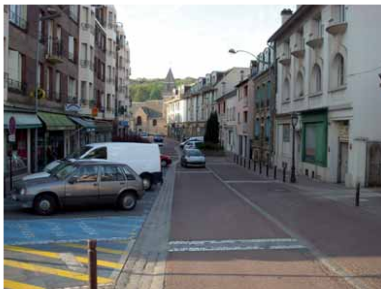
Obrázek 59: Rozdílné materiály a barvy povrchu komunikace jako zdůraznění Zóny 30 (Francie)
