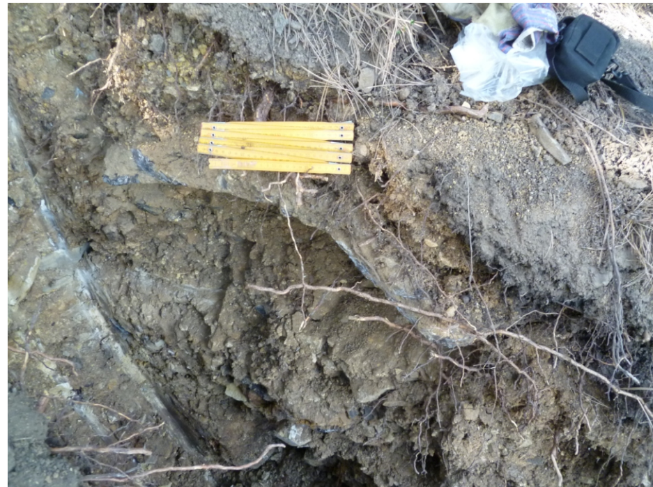
Foto č. 2. Kus asfaltu v sondě K 3
